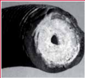
„Arterienverkalkung“ im fortgeschrittenen Stadium.
